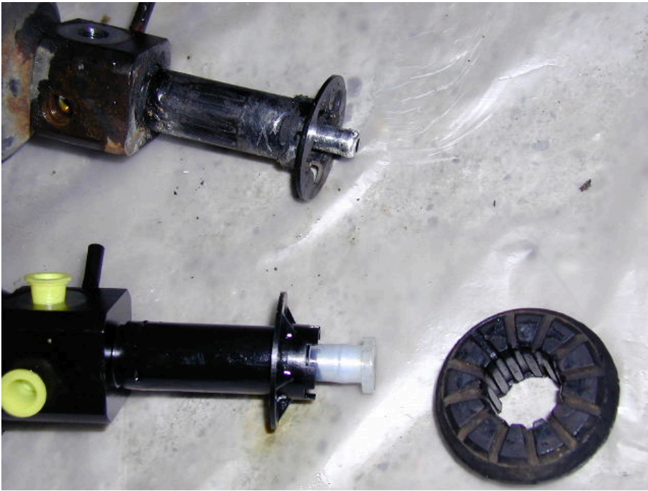
die Anschläge waren unterschiedlich montiert
