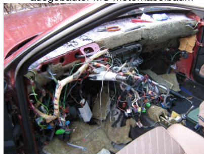
ausgebauter MC Motorkabelbaum
