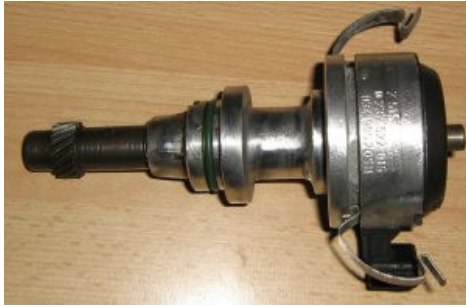
Verteiler nach der Revidierung
