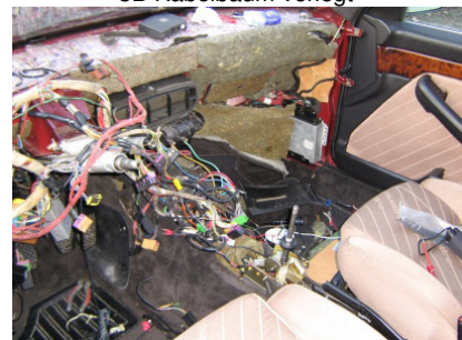
3B Kabelbaum verlegt
